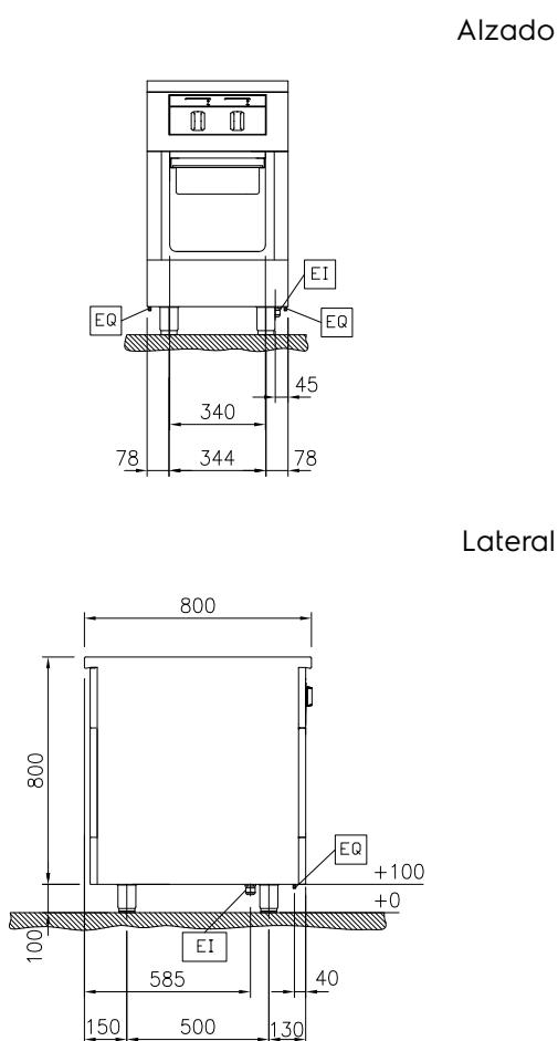
EI = Conexión eléctrica (energía)
